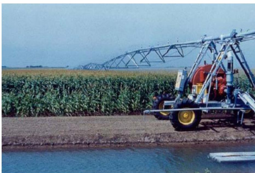
الخط الفرعي مجهز بفوهات رذاذية تعمل بضغط منخفض
