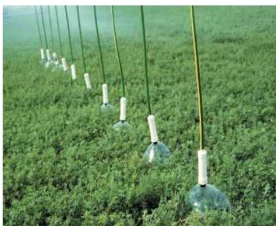
الخط الفرعي مجهز بفوهات رذاذية تعمل بضغط منخفض
