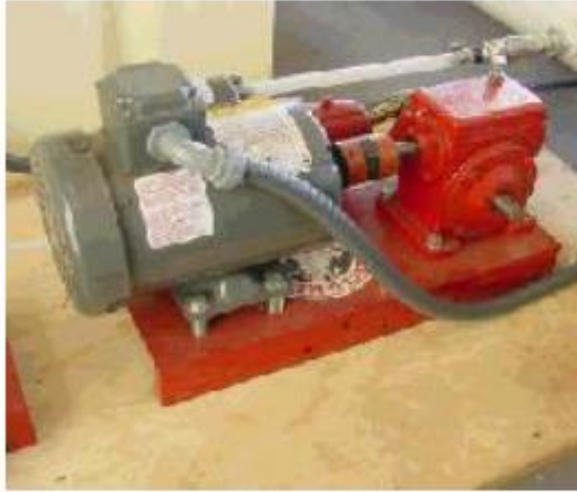
شكل (3-12) مضخات حقن الكيماويات
